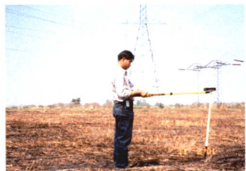
รูปที่ 4.20 การวัดค่าความเข้มสนามไฟฟ้าและสนามแม่เหล็กใต้แนวสายส่งด้วยเครื่องมือวัด
