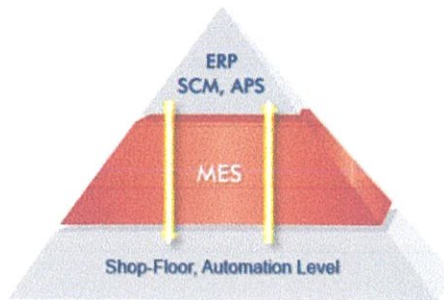
รูปที่ 1 MES ช่วยให้สายการผลิตกับระบบการจัดการทำงานสอดคล้องกัน
