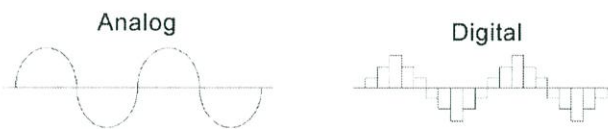
รูปที่ 3 ลักษณะสัญญาณอนาล็อก และสัญญาณดิจิทัล
