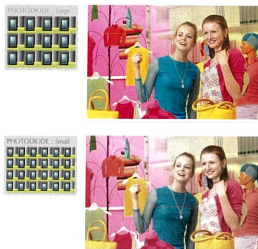
รูปที่ 2.14 เปรียบเทียบความต่างของภาพที่มีจำนวน Photosite ต่างกัน
