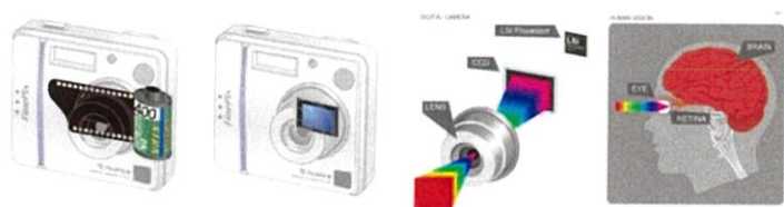
รูปที่ 2.11 การทำงานของของเซ็นเซอร์รับภาพ
