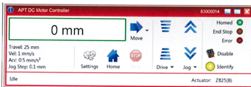
รูปที่ 3.25 interface ของซอฟต์แวร์ที่ทำหน้าที่ควบคุม DC servo motor
