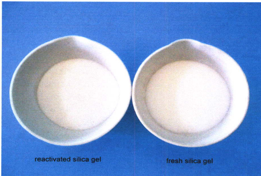
ภาพที่ ๔ แสดงการเปลี่ยนแปลงของซิลิกาเจลหลังผ่านการเผา 20 ครั้ง
