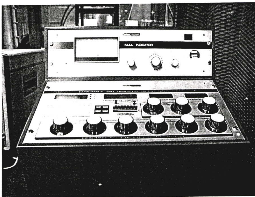
รูปที่ 6.6 เครื่องวัด Capacitance and dissipation factor ( \tan \delta ) bridge type 2809 a
