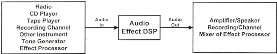
รูปที่ 5.6 แสดงระบบการประมวลผลสัญญาณเสียง
