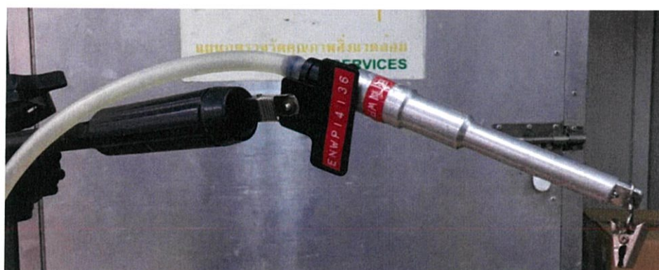
รูปที่ 3.11 หลอดดูดซับที่ติดตั้งกับชุดเก็บตัวอย่างพร้อมฝาครอบปิดกันแสง (ที่มา: ศรัณย์ ศิริสุรพงศ์. 2561.)
