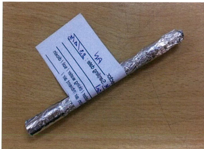
รูปที่ 3.14 หลอดดูดซับที่ปิดด้วย Sealing cap แล้วห่อด้วยอลูมิเนียมฟอยล์ (ที่มา: ศรีณย์ ศิริสุรพงศ์. 2561.)
