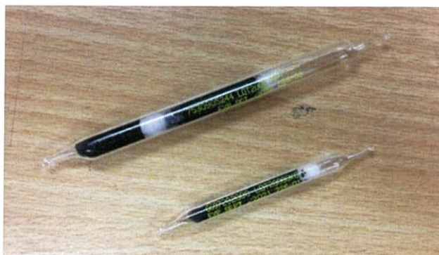
รูปที่ 3.2 หลอดดูดซับ (Sorbent tube) (ที่มา: ศรัณย์ ศิริสุรพงศ์. 2561.)
