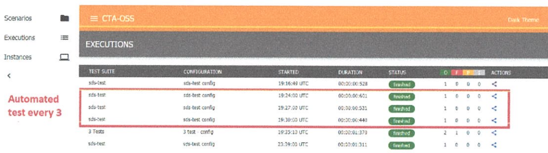
รูปที่ 5.15 ตัวอย่างการแสดงผลลัพธ์ของการทดสอบซอฟต์แวร์แบบอัตโนมัติทุกๆ 3 นาที
