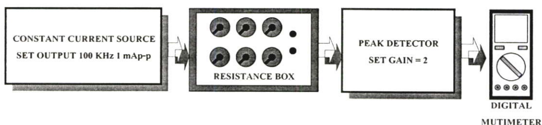
รูปที่ 7.15 การต่อวงจรเพื่อวัดค่าความถี่ของวงจรดีมอดูเลเตอร์แบบตรวจจับสัญญาณแรงดันยอด
