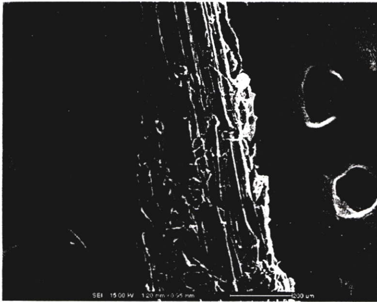
รูปที่ ก.2 แสดงพื้นผิวของเส้นใยที่ผ่านการขึ้นรูป( กำลังขยาย165 เท่า )
