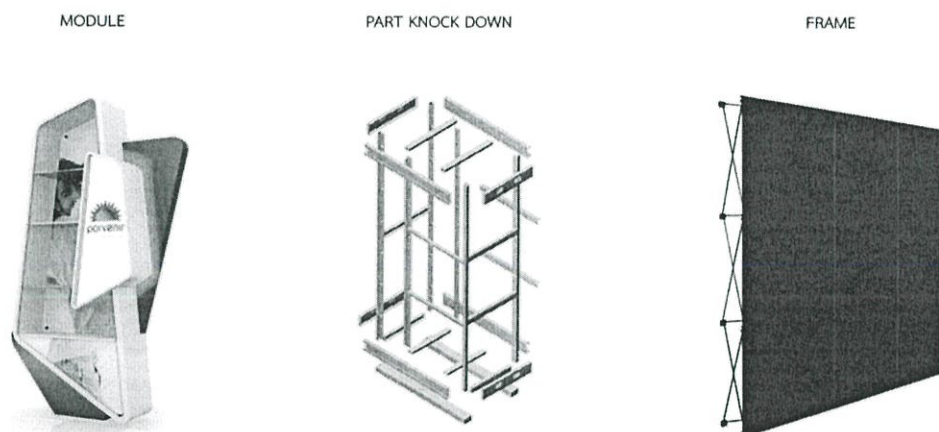
รูปที่ 3.7 แสดงรูปแบบการติดตั้ง Module , Part Knock Down , Frame
