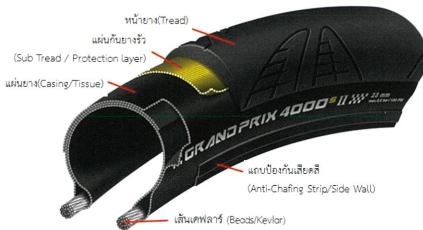
ภาพที่ 2.2 โครงสร้างของยางจักรยาน
