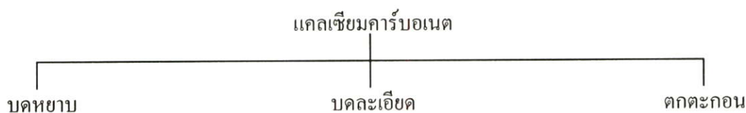
รูปที่ 2.1 การแบ่งเกรดของแคลเซียมคาร์บอเนต [5]
