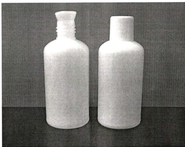
รูปที่ 3.2 ลักษณะผลิตภัณฑ์ขวดที่ได้จากการเป่าขึ้นรูป
