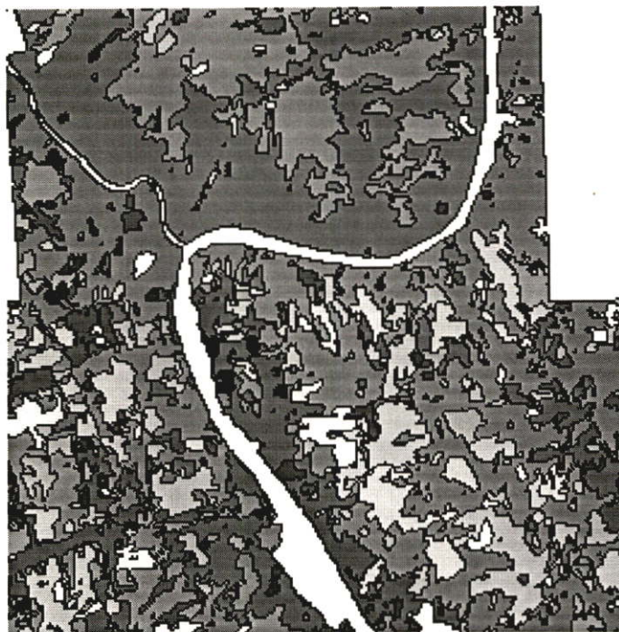
รูปที่ 4.15 ผลการแบ่งส่วนภาพด้วยทฤษฎีกราฟ เมื่อแบ่งภาพออกเป็น 1000 ส่วน ของภาพ ที่ผ่านการรักษาขอบแบบปรับเรียบ
