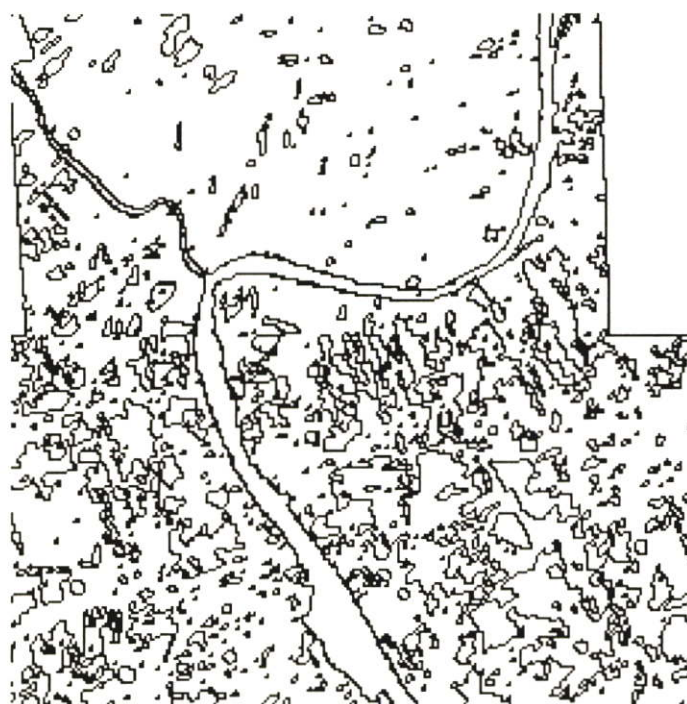
รูปที่ 4.9 ผลของการเข้ารหัสขอบแบบ 4 ทิศทาง เมื่อแบ่งภาพออกเป็น 1000 ส่วน ของภาพที่ไม่ผ่านการรักษาขอบ
