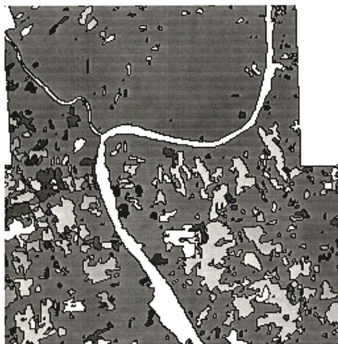
รูปที่ 4.16 ผลการแบ่งส่วนภาพด้วยทฤษฎีกราฟ เมื่อแบ่งภาพออกเป็น 500 ส่วน ของภาพ ที่ผ่านการรักษาขอบแบบปรับเรียบ
