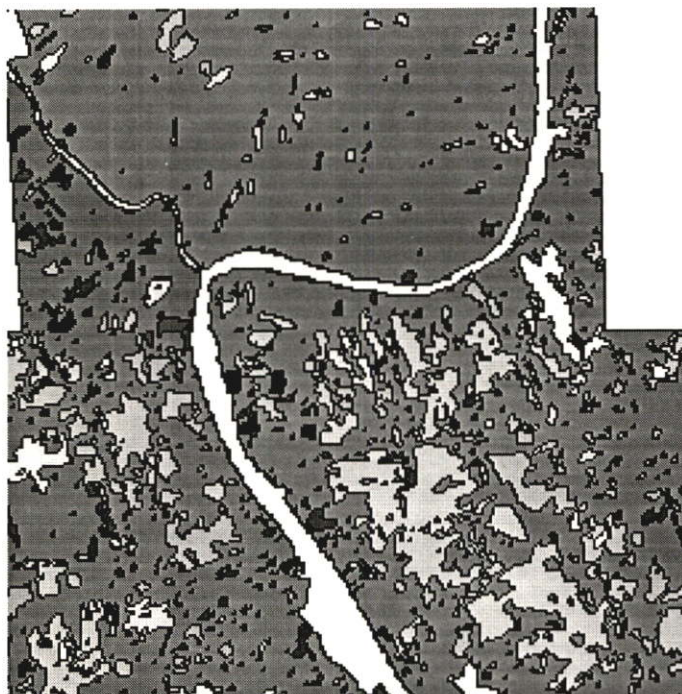
รูปที่ 4.11 ผลการแบ่งส่วนภาพด้วยทฤษฎีกราฟ เมื่อแบ่งภาพออกเป็น 1000 ส่วน ของภาพที่ไม่ผ่านการรักษาขอบ
