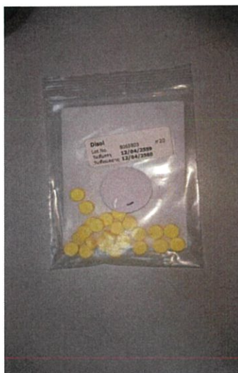
รูปที่ 3.4 ตำแหน่งในการติด Tag NFC บนซองยา
