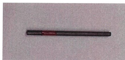
รูปที่ 3.1 ภาพแสดงลักษณะเส้ดินสอดแกรไฟต์ที่พันด้วยอินซูเลเตอร์
