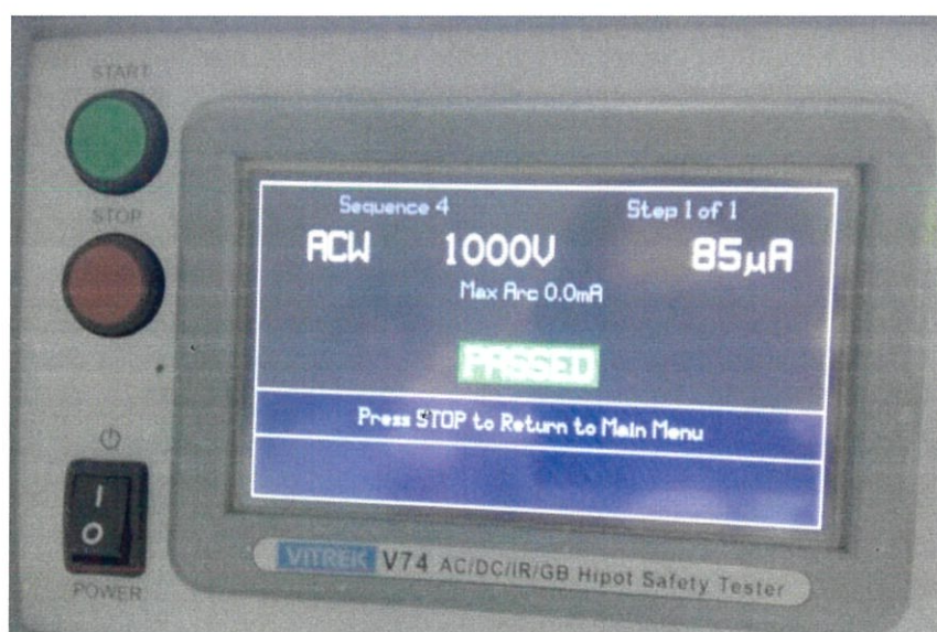
รูปที่ 4.24 ผลการทดสอบ HiPot ที่ 1000 \text{ V}
