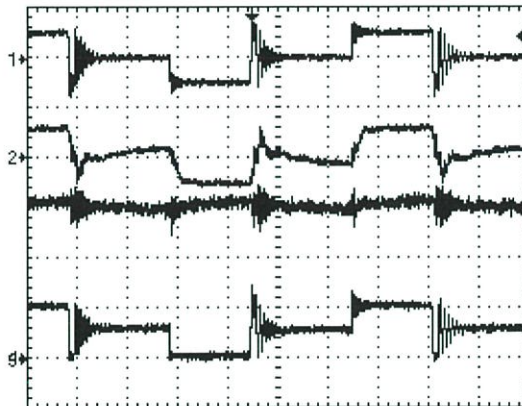
v_L [100V/div], i_L [20A/div], i_{in} [2A/div], v_{DS} [50V/div] จากบนลงล่าง รูปที่ 4.23 รูปสัญญาณเมื่อใช้โหลดโหลดไฟ 60 โหลด @ V_{in} = 50 V
