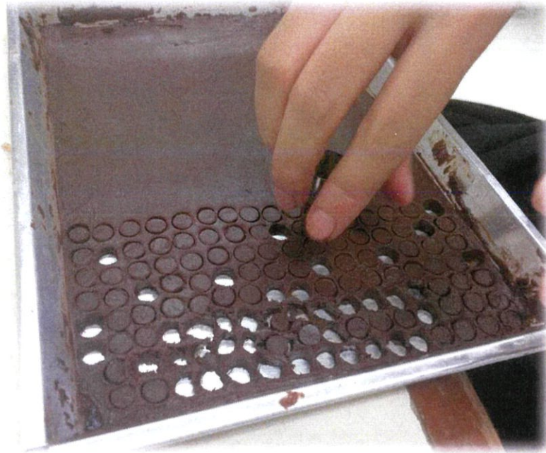
รูปที่ 3.1 แสดงการเตรียมเม็ดช็อกโกแลตโดยใช้หัวกดขนาด 0.82 มิลลิเมตร
