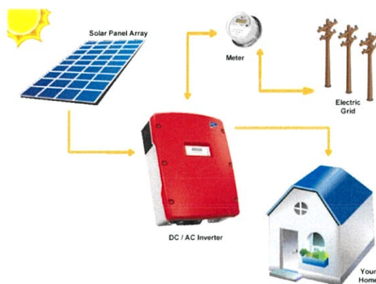
รูปที่ 2.4 เซลล์แสงอาทิตย์ระบบ Grid-Tied
