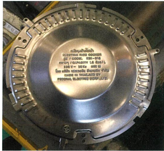
ข. แผ่นโลหะที่ผ่านการปั๊มรายละเอียดข้อมูล
