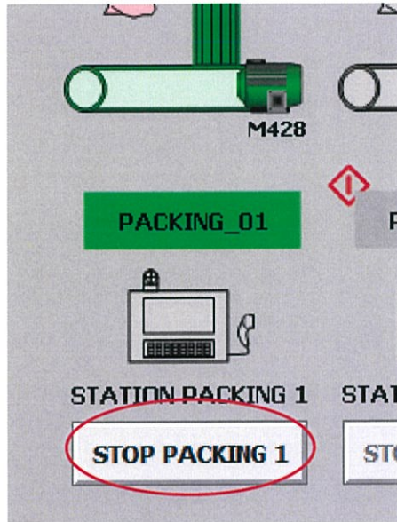
รูปที่ 4.6 แสดงปุ่ม Stop ที่สามารถกดได้หลังจากอุปกรณ์ทุกตัวใน Station Packing เปิดหมดแล้ว
