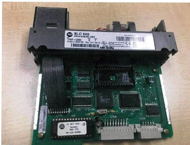
รูปที่ 2.8 ลักษณะของหน่วยประมวลผลกลางของ PLC ยี่ห้อ Allen-Bradley SLC 500
