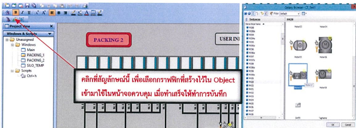
รูปที่ 3.15 การดึงกราฟฟิกใน Object มาใช้ในซอฟต์แวร์ InTouch WindowMaker
