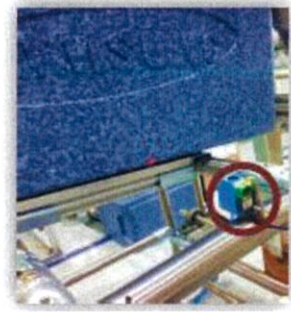
สถานะเมื่อมีสิ่งกีดขวางของเซนเซอร์ จะแสดงไฟสีเขียวและเหลือง
