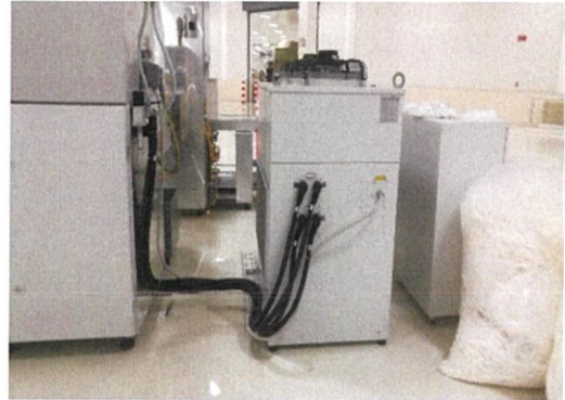
ภาพที่ 4.3 คูลเลอร์ (Cooler) ที่ติดตั้งเพิ่มในกลุ่มเครื่องจักรโมโนไลน์โดยไม่ได้มีการแจ้งล่วงหน้า
