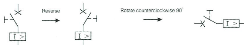
รูปที่ 3.33 แสดงมาตรฐานการกลับสัญลักษณ์แนวตั้ง เป็นแนวนอน
