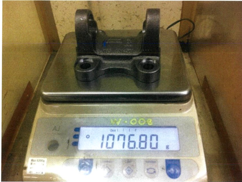
รูปที่ 3.30 การชั่งมวลของหน้าแปลนก้ามปูหลังจากทำการตกแต่งตามการออกแบบเดิม
