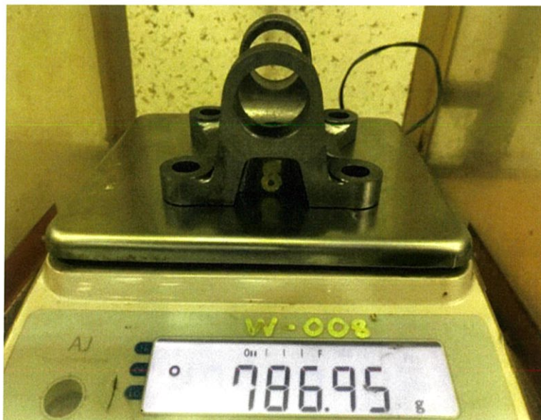
รูปที่ 4.19 การชั่งมวลของหน้าแปลนก้ามปูหลังจากทำการหล่อขึ้นรูปตามการออกแบบปรับปรุงใหม่
