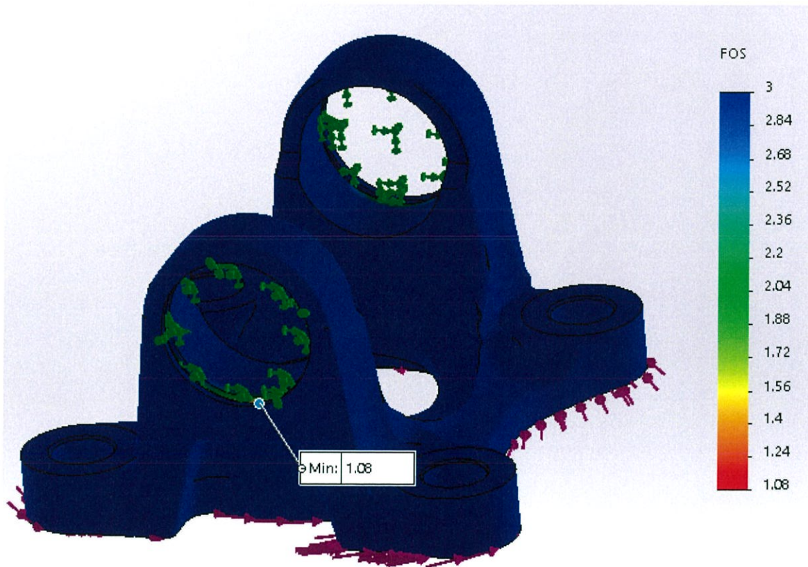
รูปที่ 4.3 แสดงค่าตัวประกอบความปลอดภัยของหน้าแปลนก้ำมปูตามการออกแบบปรับปรุงใหม่ กรณีที่หน้าแปลนก้ำมปูติดกับเครื่องยนต์
