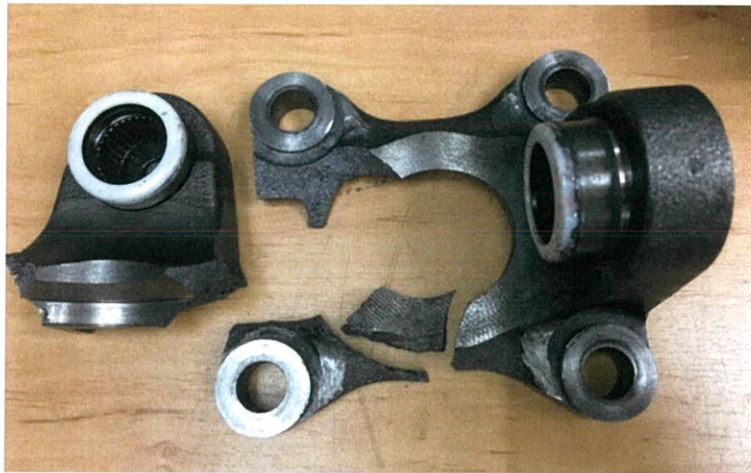
รูปที่ 4.11 ความเสียหายที่เกิดขึ้นกับหน้าแปลนก้ามปูตามการออกแบบปรับปรุงใหม่ชิ้นงานที่ 1
