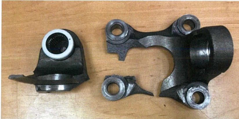
รูปที่ 4.13 ความเสียหายที่เกิดขึ้นกับหน้าแปลนก้ำมปูตามการออกแบบปรับปรุงใหม่ชิ้นงานที่ 3
