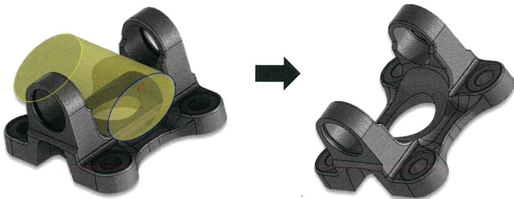
รูปที่ 3.15 การลดมวลของวัสดุบริเวณแนวกลางขนานกับฐานของหน้าแปลนก้ำมปูหลังจากทำการตกแต่ง
