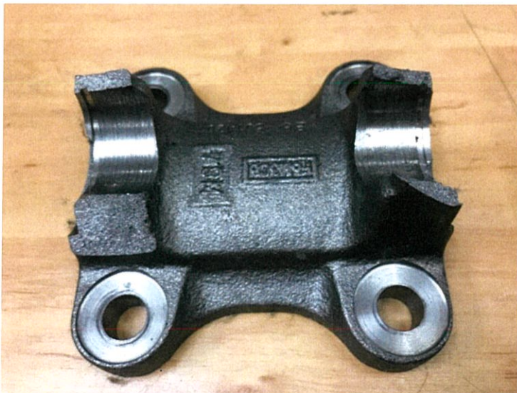
รูปที่ 4.6 ความเสียหายที่เกิดขึ้นกับหน้าแปลนกำมปูตามการออกแบบเดิมชิ้นงานที่ 2
