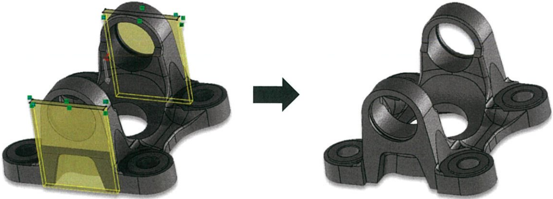
รูปที่ 3.18 การลดมวลของวัสดุบริเวณด้านนอกของหูของหน้าแปลนก้ามปูหลังจากทำการตกแต่ง
