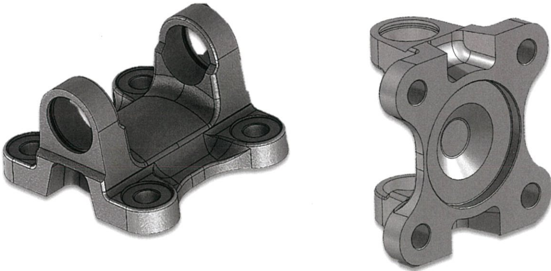
รูปที่ 3.3 แบบจำลองของหน้าแปลนก้ำมปูหลังจากทำการตกแต่งตามการออกแบบเดิม
