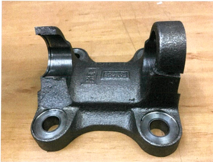
รูปที่ 4.5 ความเสียหายที่เกิดขึ้นกับหน้าแปลนกำมปูตามการออกแบบเดิมชิ้นงานที่ 1
