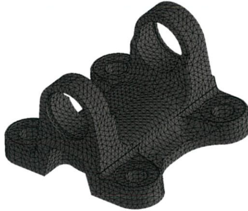
รูปที่ 3.25 แบบจำลองของหน้าแปลนก้ามปูหลังจากทำการตกแต่งตามการออกแบบเดิมที่ผ่านการสร้างเอลิเมนต์แล้ว
