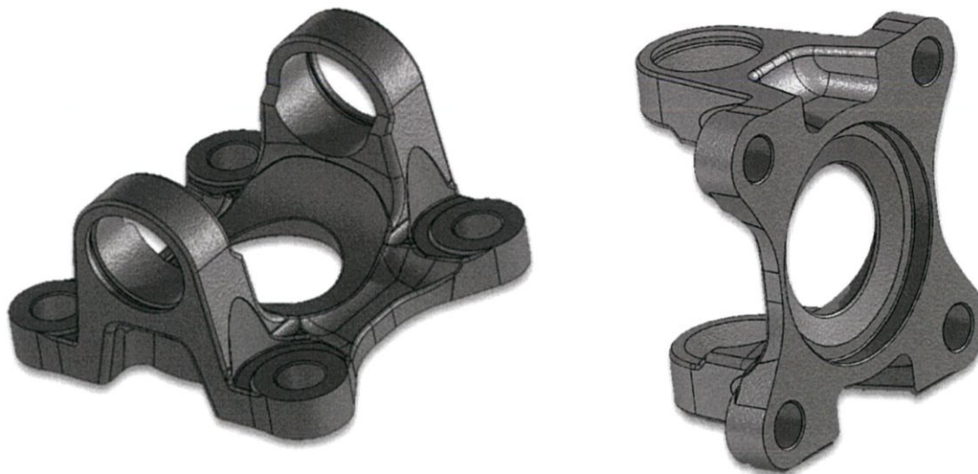
รูปที่ 3.20 แบบจำลองของหน้าแปลนก้ามปูหลังจากทำการตกแต่งตามการออกแบบปรับปรุงใหม่
