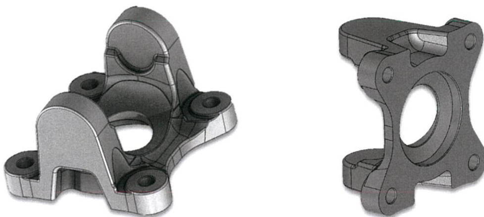
รูปที่ 3.13 แบบจำลองของหน้าแปลนก้ามปูหลังจากทำการหล่อขึ้นรูปตามการออกแบบปรับปรุงใหม่
