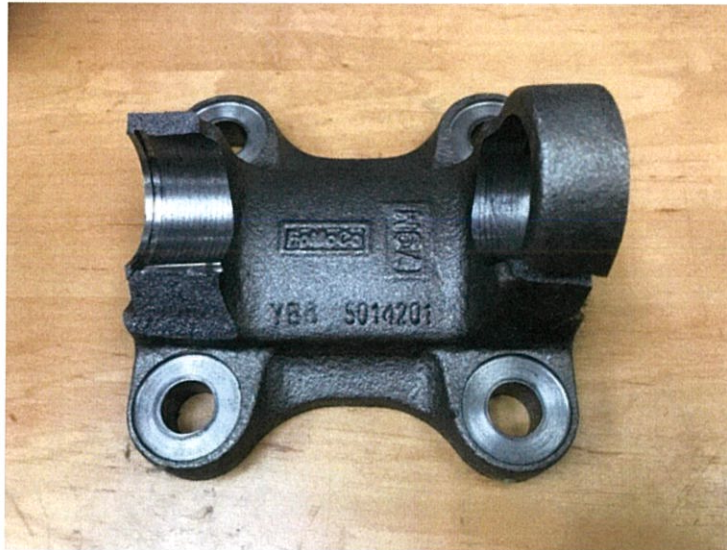
รูปที่ 4.7 ความเสียหายที่เกิดขึ้นกับหน้าแปลนกำมปูตามการออกแบบเดิมชิ้นงานที่ 3
