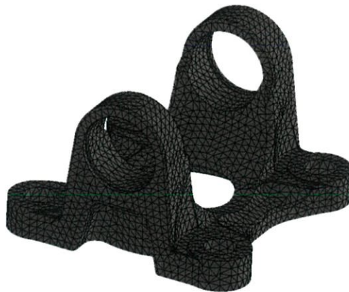
รูปที่ 3.26 แบบจำลองของหน้าแปลนก้ามปูหลังจากทำการตกแต่งตามการออกแบบปรับปรุงใหม่ ที่ผ่านการสร้างเอลิเมนต์แล้ว
