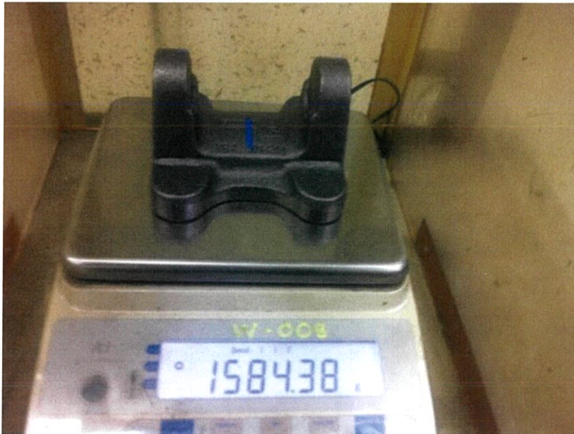
รูปที่ 3.28 การชั่งมวลของหน้าแปลนก้ามปูหลังจากทำการหล่อขึ้นรูปตามการออกแบบเดิม
