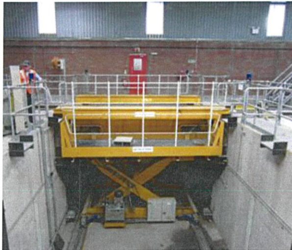
รูปที่ 2.20 โต๊ะเลื่อนแคร่ที่ศูนย์ซ่อมบำรุง Oxley , Wloverhapmton, UK. [2]
