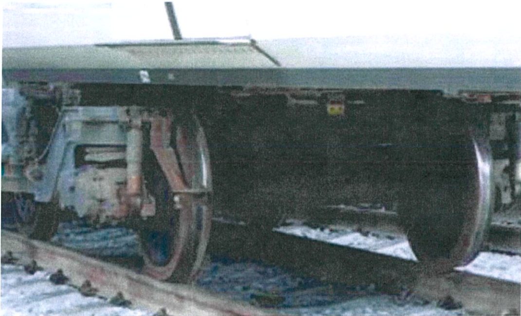
รูปที่ 2.4 แสดงตัวอย่างของแคร่แบบไม่มีระบบขับเคลื่อน ของรถไฟฟ้าแอร์พอร์ต เรลล์ ลิงก์ [3]
