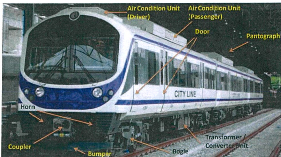
รูปที่ 2.1 แสดงส่วนภายนอกของรถไฟฟ้าแอร์พอร์ต เรลล์ ลิงก์ [3]
