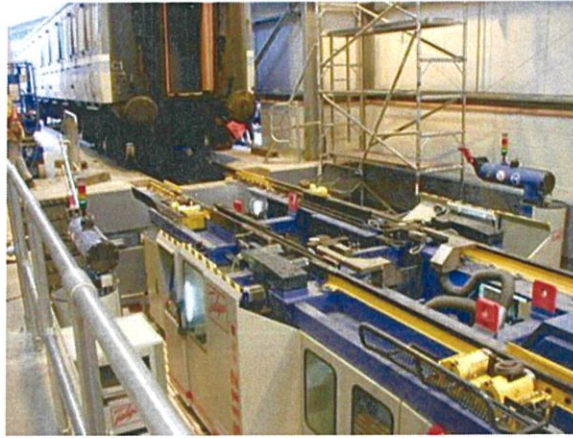
รูปที่ 2.15 ตัวอย่างเครื่องกลึงล้อใต้พื้นในพื้นที่ปฏิบัติการที่ Aylesbury, UK. [2]
