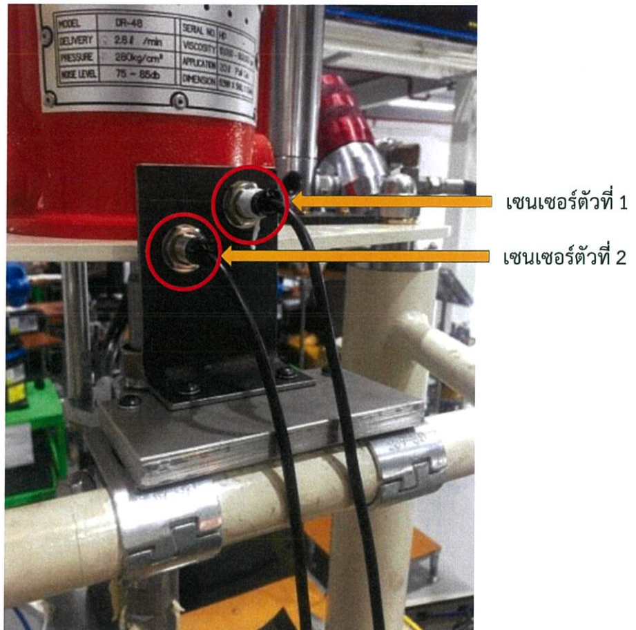
รูปที่ ก-15 รูปแสดงเซนเซอร์ที่ใช้สำหรับเตือนจากระยะปีใกล้หมด
