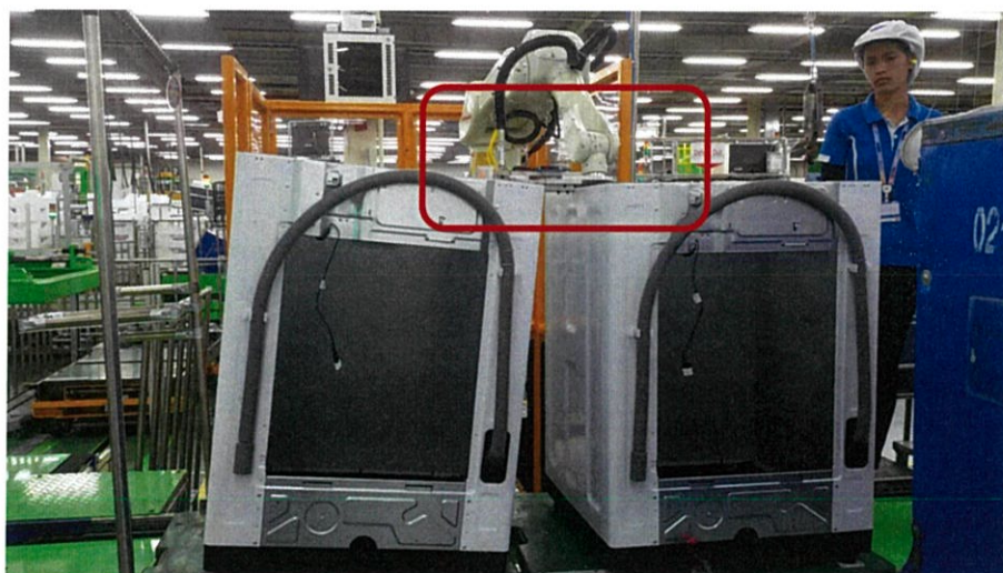
รูปที่ ก-17 หุ่นยนต์หยุดทำงานค้างอยู่บนโครงเครื่องซักผ้า
