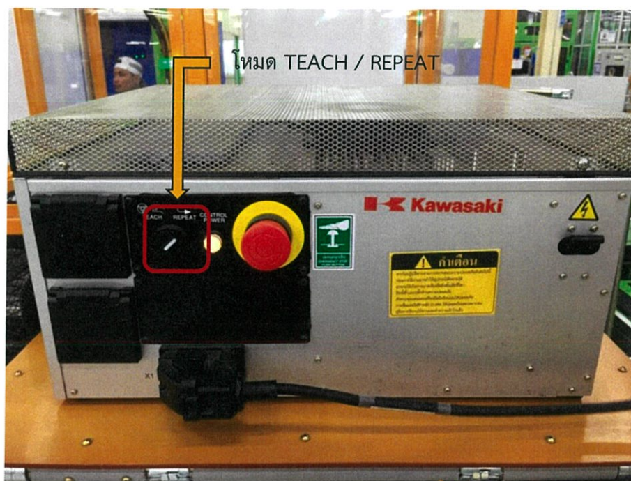
รูปที่ ก-19 Selector Switch สำหรับเปลี่ยนโหมด TEACH หรือ REPEAT
