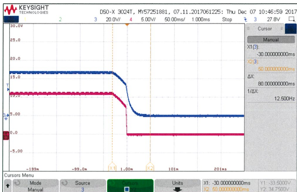
รูปที่ 4.9 รูปสัญญาณ Fall Time ของแรงดันเอาต์พุต 48V (CH3 : 20V/div) และสัญญาณแรงดันเอาต์พุต 12V (CH4 : 5V/div) ที่ V_{in} = 220V_{rms}/50Hz และดิ่งโหลดสูงที่สุด (48V/12.28A, 12V/6.5A)
