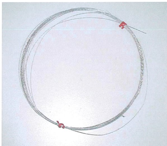
รูปที่ ก.19 ภาพถ่ายเชือกสลิงที่ใช้ในการดิ่งภาวะ
