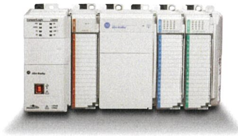
ภาพที่ 2.8 PLC ชนิดโมดูล
