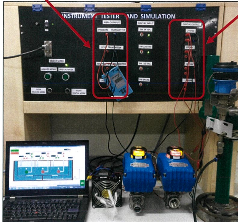
ภาพที่ 3.26 แสดงการต่อใช้งาน Hardware input และ output กับชุดทดสอบ
