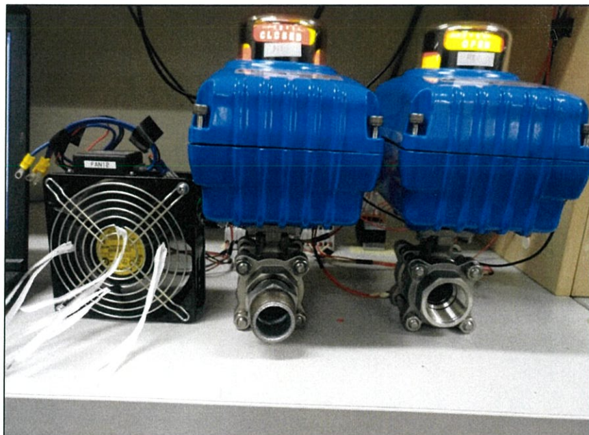
ภาพที่ 4.5 รีเลย์จากภาพที่ 4.4 สั่งงานให้ Actuator ทำงานได้ตามลอจิก
