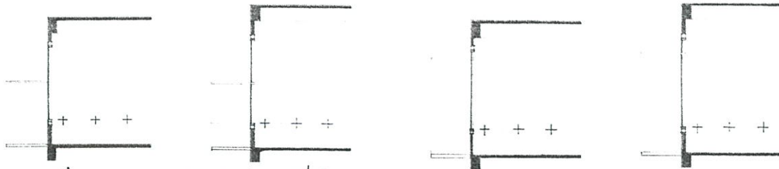
ภาพที่ 5.14 แสดงรูปตัดหุ่นจำลองที่ใช้ทดสอบหาความสูงของเพดาน Light Shelf สูง 2.00 เมตร
