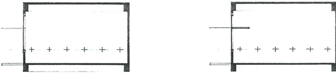
ภาพที่ 5.8 แสดงรูปตัดหุ่นจำลองที่ใช้ทดสอบผิววัสดุของ Light Shelf ระยะยื่น 1.20 เมตร
