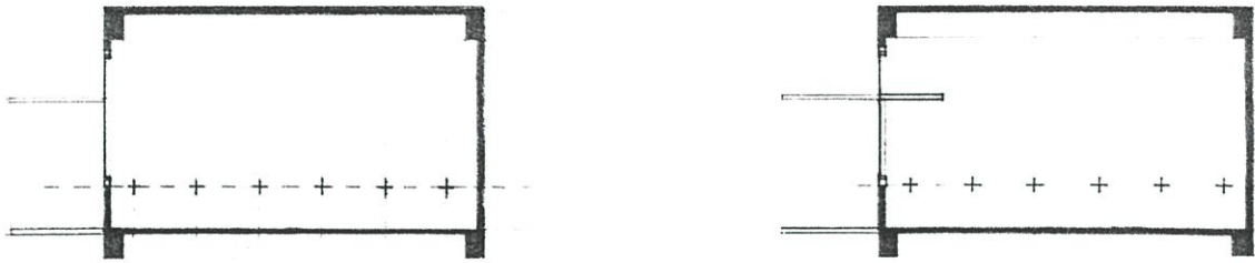
ภาพที่ 5.5 แสดงรูปตัดหน้าจำลองที่ใช้ทดสอบ Light Shelf ระยะยื่น 1.50 เมตร
