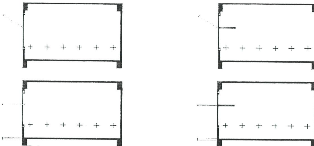
ภาพที่ 5.11 แสดงรูปตัดหุ่นจำลองที่ใช้ทดสอบ Light Shelf ความเอียง 30 องศาและ 90 องศา
