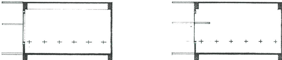
ภาพที่ 5.3 แสดงรูปตัดหุ่นจำลองที่ใช้ทดสอบ Light Shelf แบบที่มี Overhang และแบบผสม
