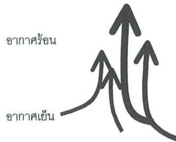
ภาพที่ 2.3 แสดงถึงอากาศเย็นจะเคลื่อนเข้าแทนที่อากาศร้อน ทำให้อากาศร้อนลอยตัวสูงขึ้น
