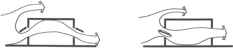
ภาพที่ 2.40 การใช้ช่องเปิดลักษณะลักษณะแบบบานกระทุ้ง ช่วยทำให้เกิดแนวการไหลของกระแสลมที่ต่างกัน
