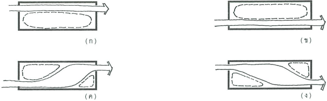
ภาพที่ 2.25 การไหลของอากาศจากช่องทางเข้าในตำแหน่งที่ต่างกัน
