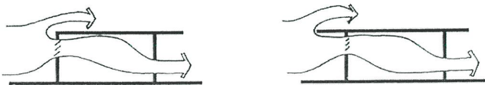
ภาพที่ 2.34 การใช้ชายคาและบานเกล็ดในการทำให้เกิดแนวการไหลของกระแสลมที่ต่างกัน
