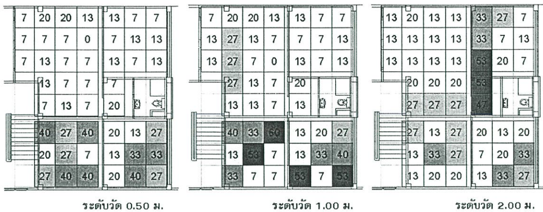
ภาพที่ 5.3 ความเร็วลมช่องลมออกระดับต่างๆ
