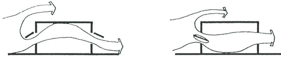
ภาพที่ 2.36 การใช้ช่องเปิดลักษณะแบบบานกระทุ้ง ช่วยทำให้เกิดแนวการไหลของกระแสมที่ต่างกัน
