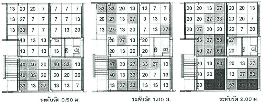
ภาพที่ 5.2 ความเร็วลมช่องลมเข้าระดับต่างๆ
