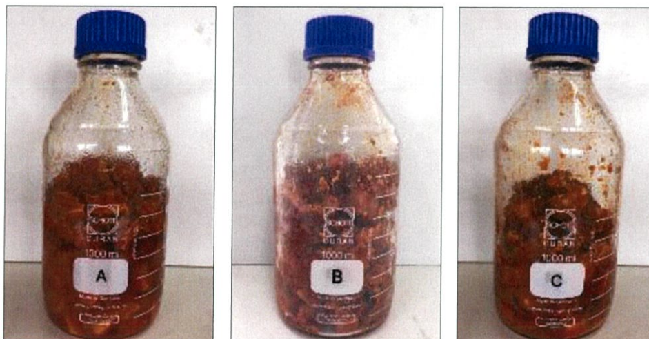
A = 121 องศาเซลเซียส 15 นาที, B= 116 องศาเซลเซียส 5 นาที, C= 115 องศาเซลเซียส 6 นาที
