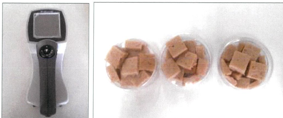
รูปที่ ก-4 เครื่องวัดสีรุ่น MiniScan EZ และลักษณะการเตรียมตัวอย่างลงในพอร์ตวัดสี
