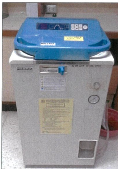
รูปที่ ก-11 หม้อนึ่งอัดไอน้ำ (Autoclave)
