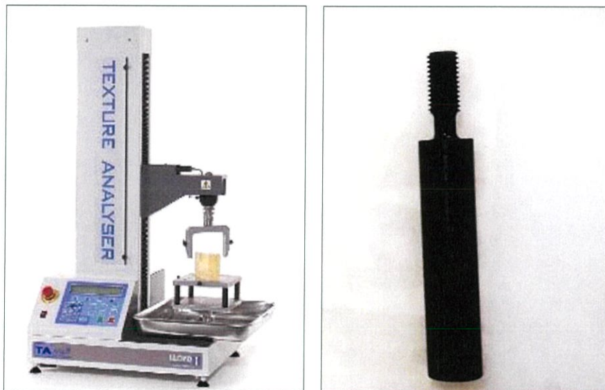
รูปที่ ก-8 เครื่องวัดเนื้อสัมผัสและหัววัด (cylinder probe) ขนาด 10 มิลลิเมตร ที่มา : http://sc-intro.blogspot.com
