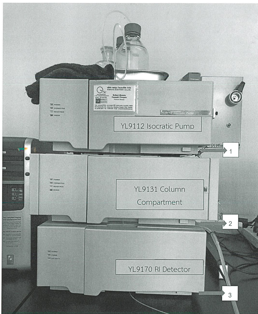
รูปที่ ค.1 สวิตช์ในการเปิด-ปิด YL9112 Isocratic pump YL9131 column compartment และ YL9170 RI detector
