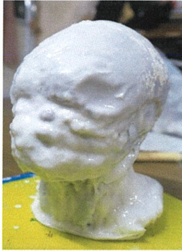
ภาพที่ 4.10 ภาพการเทซิลิโคนเพื่อทำแม่พิมพ์ส่วนหัว
