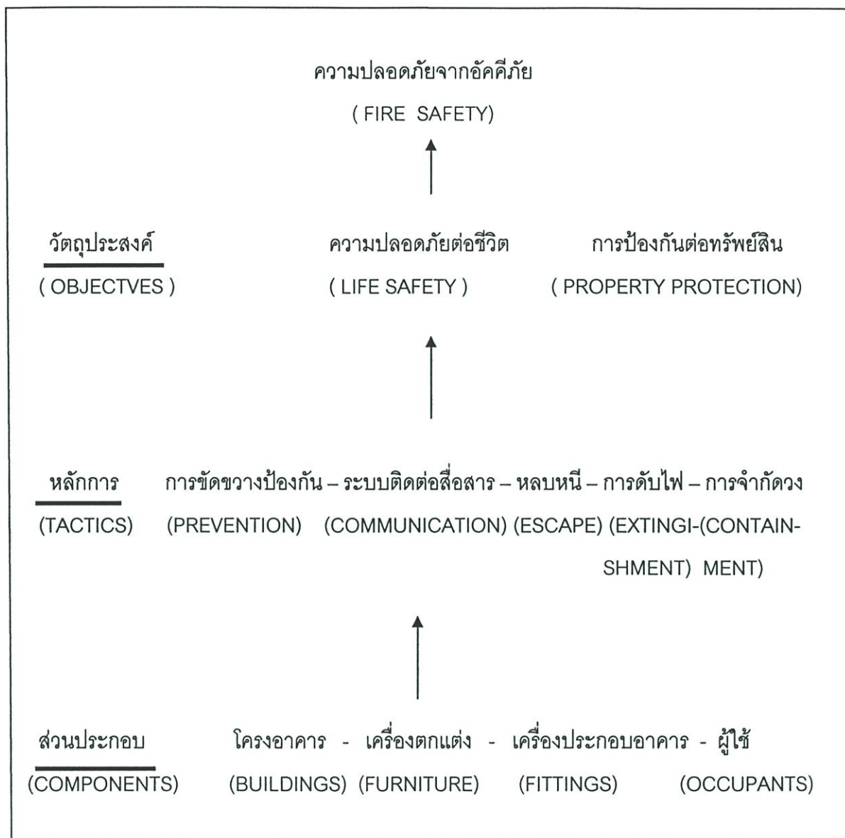
รูปที่ 2.34 แผนผังการจัดลำดับส่วนประกอบของการป้องกันอัคคีภัย
