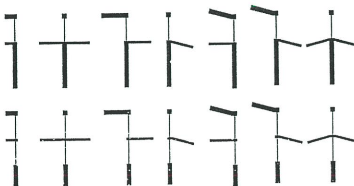
รูปที่ 2.6 แสดงรูปแบบทั่วไปของ Light Shelf ที่มีการใช้งานจริง ที่มา : Claude (1986 : 123)
