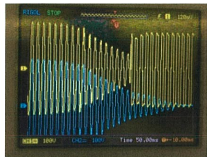
รูปที่ 9 กราฟชดเชยแรงดันตกชั่วขณะให้ขดลวดของตัวตัดต่อวงจรจำนวน 1 ตัว ที่ระดับแรงดันอ้างอิง 150 โวลต์
