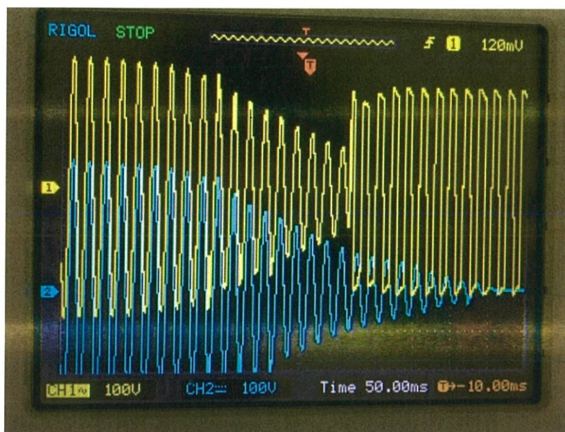
รูปที่ 4.10 กราฟการชดเชยแรงดันที่แรงดันอ้างอิง 150 โวลต์ ครั้งที่ 3
