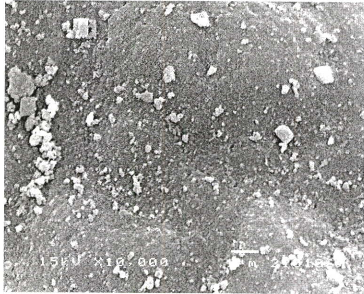
รูปที่ 4.13 SEM ของซีโอไลต์บีต้าที่สังเคราะห์จากซิลิกาที่สกัดจากเถ้าลอยของขาน้อย อัตราส่วนซิลิกอนต่ออะลูมิเนียมเท่ากับ 5 เวลาในการตกผลึก 48 ชั่วโมง อุณหภูมิในการสังเคราะห์ 135 องศาเซลเซียส
