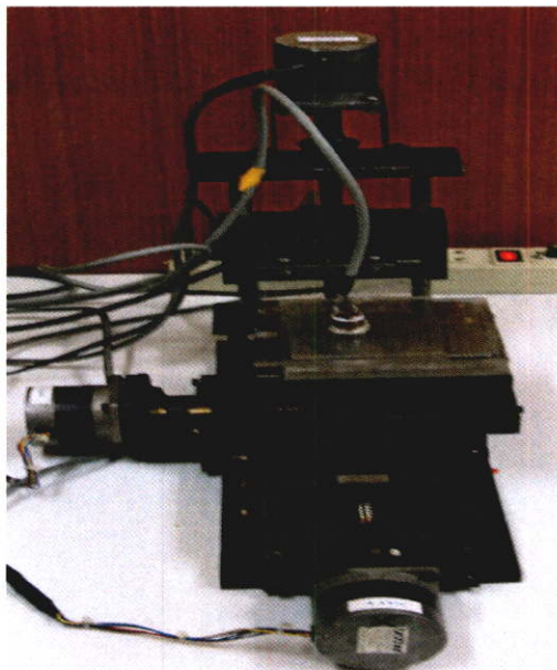
รูปที่ 3.2 แกน X-Y ที่ใช้เคลื่อนแผ่นโลหะทดสอบ
