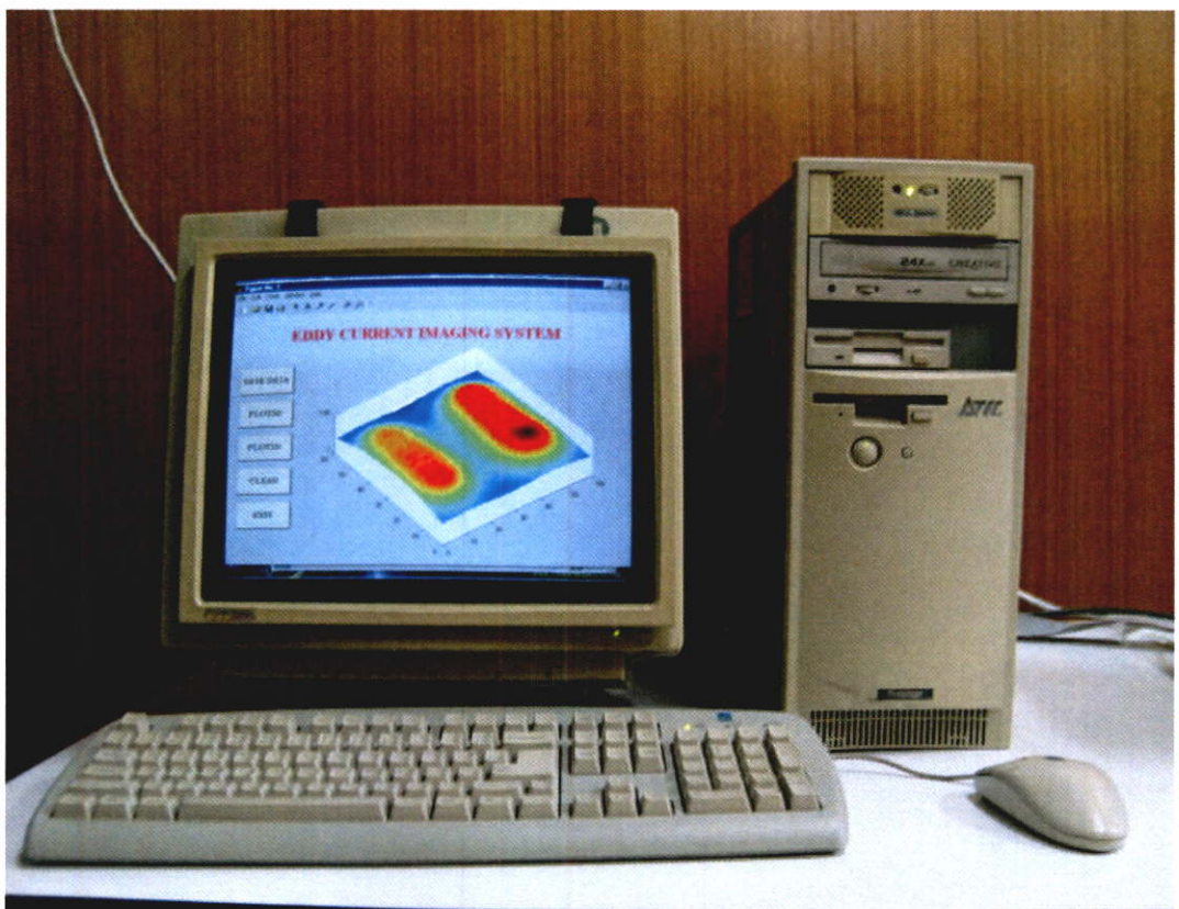
รูปที่ ก6 หน้าจอที่ใช้ควบคุมการทำงานและแสดงผลรอยบกพร่องจำลอง
