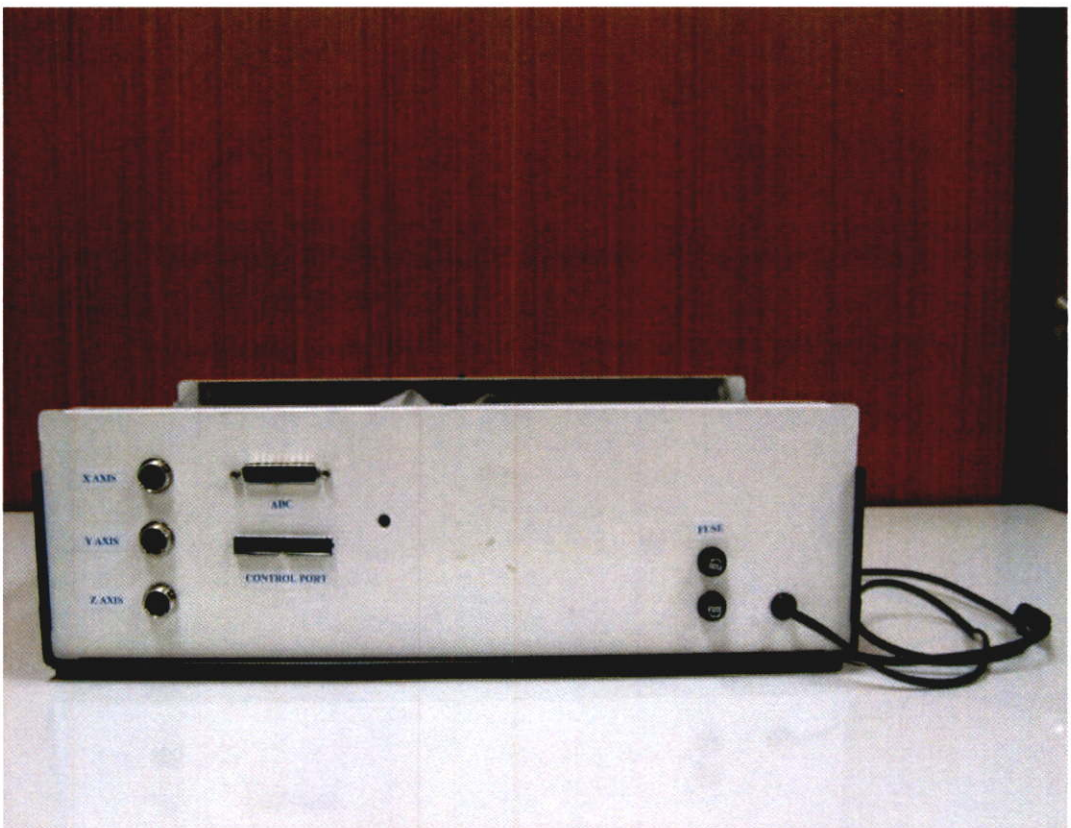
รูปที่ ก4 จุดเชื่อมต่อต่างๆ สำหรับควบคุมแกน X-Y-Z และจุดเชื่อมต่อควบคุมการรับส่งข้อมูล
