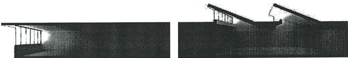
รูปที่ 2 ตัวอย่างการนำแสงธรรมชาติเข้าสู่ภายในอาคารจากด้านข้าง และด้านบน ซึ่งในบ้านเราควรเปิดช่องแสงทางทิศเหนือ
