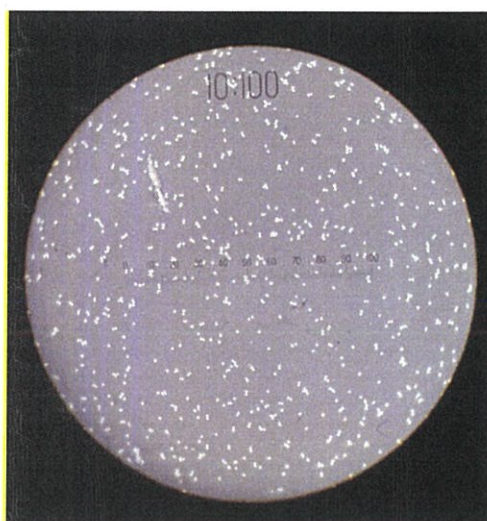
รูปที่ 4.4 ขนาดของเซลล์ที่เป็น S. aureus เมื่อย้อมด้วยสินีโกรซิน (nigrosin) แล้วส่องใต้กล้องจุลทรรศน์กำลังขยาย 1000 เท่า
