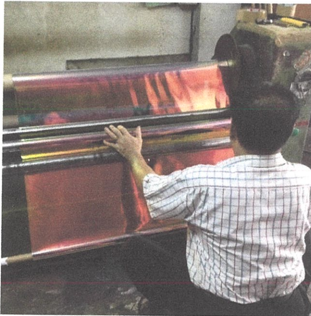
ภาพที่ 4.4 นำแผ่นพลาสติก PVC ใสเข้าเครื่องเพื่อพันให้เป็นม้วน
