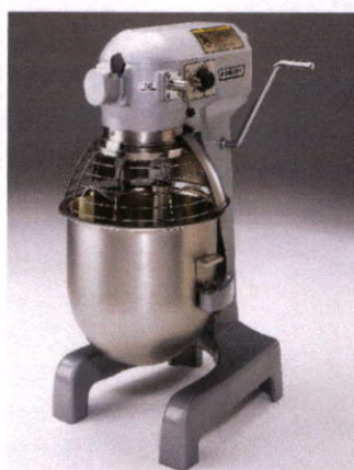
รูปที่ 3.2 เครื่องผสมซีเมนต์เพสท์ (Hobart Type)
