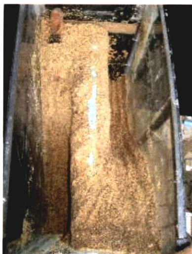
รูปที่ 3.2 การเก็บตัวอย่างแบบไม่ทำลายโครงสร้าง (undisturbed sampling)
