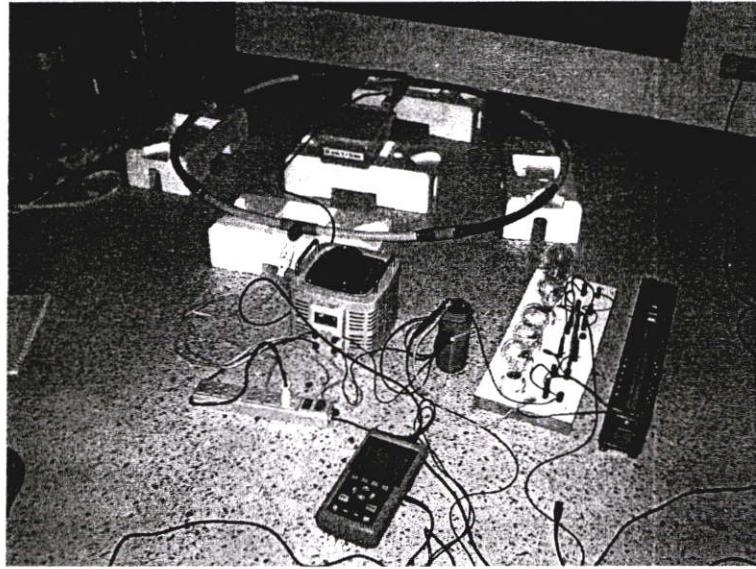
รูปที่ 5.17 การต่ออุปกรณ์กระแสแบบไฟฟ้ากระแสตรง ที่ความเข้มข้นแม่เหล็กขนาด 20 A/m (แรงดันแบบไฟฟ้ากระแสตรง ที่ความเข้มข้นแม่เหล็กขนาด 20 A/m)
