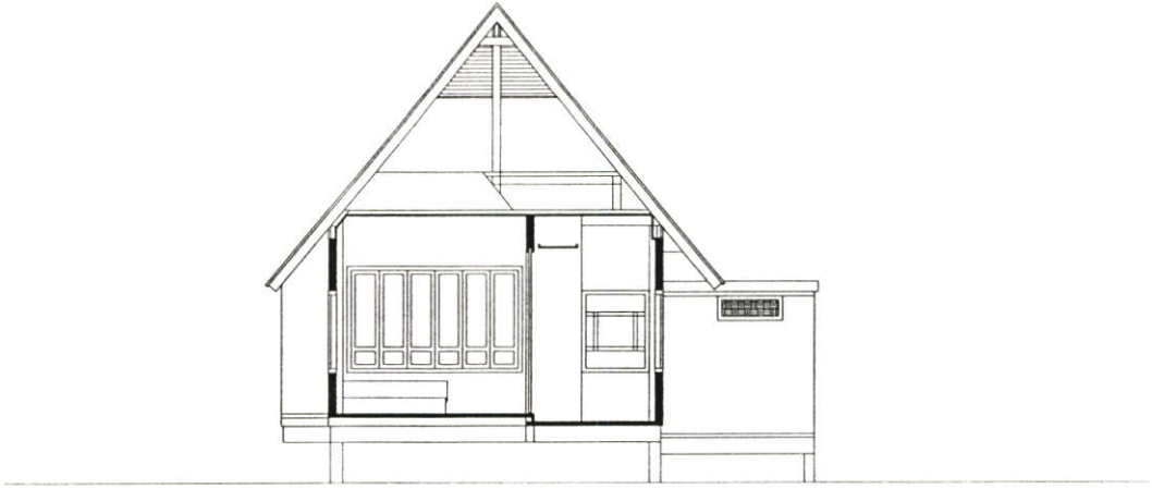
ภาพที่ 6.12 แบบตัวอย่างรูปตัดตามขวางของบังกะไลเชิงนิเวศชายทะเล ภาคตะวันออก
