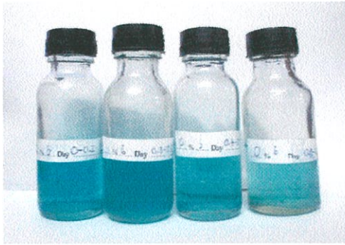
(ก) เวลาทดสอบ 6 วัน ความชื้น 0 % ด้านรัศมี ระยะความลึก 0-1.2 เซนติเมตร
