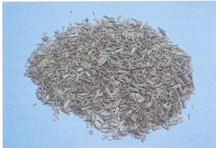
รูปที่ 4.23 ลักษณะของคอมโพสิตไม้พญาสัตบรรณที่มีขนาด 20 เมส ที่นำมาสกัดด้วยภาวะ PMMA ออกด้วยตัวทำละลายไคลซีน เพื่อใช้วิเคราะห์น้ำหนักโมเลกุลของพอลิเมอร์ ที่สภาวะในการพอลิเมอร์ไรเซชันต่างๆ กัน
