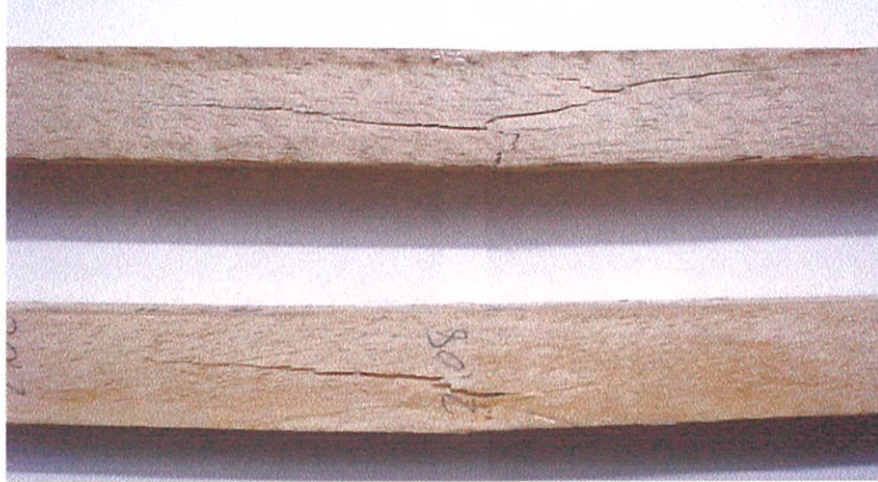
รูปที่ 4.52 แสดงลักษณะการแตกหักของชิ้นไม้ทดสอบหาค่าการดัดสถิตย์ของคอมโพสิตไม้พญาสัตบรรณ ที่มีปริมาณพอลิเมอร์ในเนื้อไม้ ประมาณ 20 เปอร์เซ็นต์
