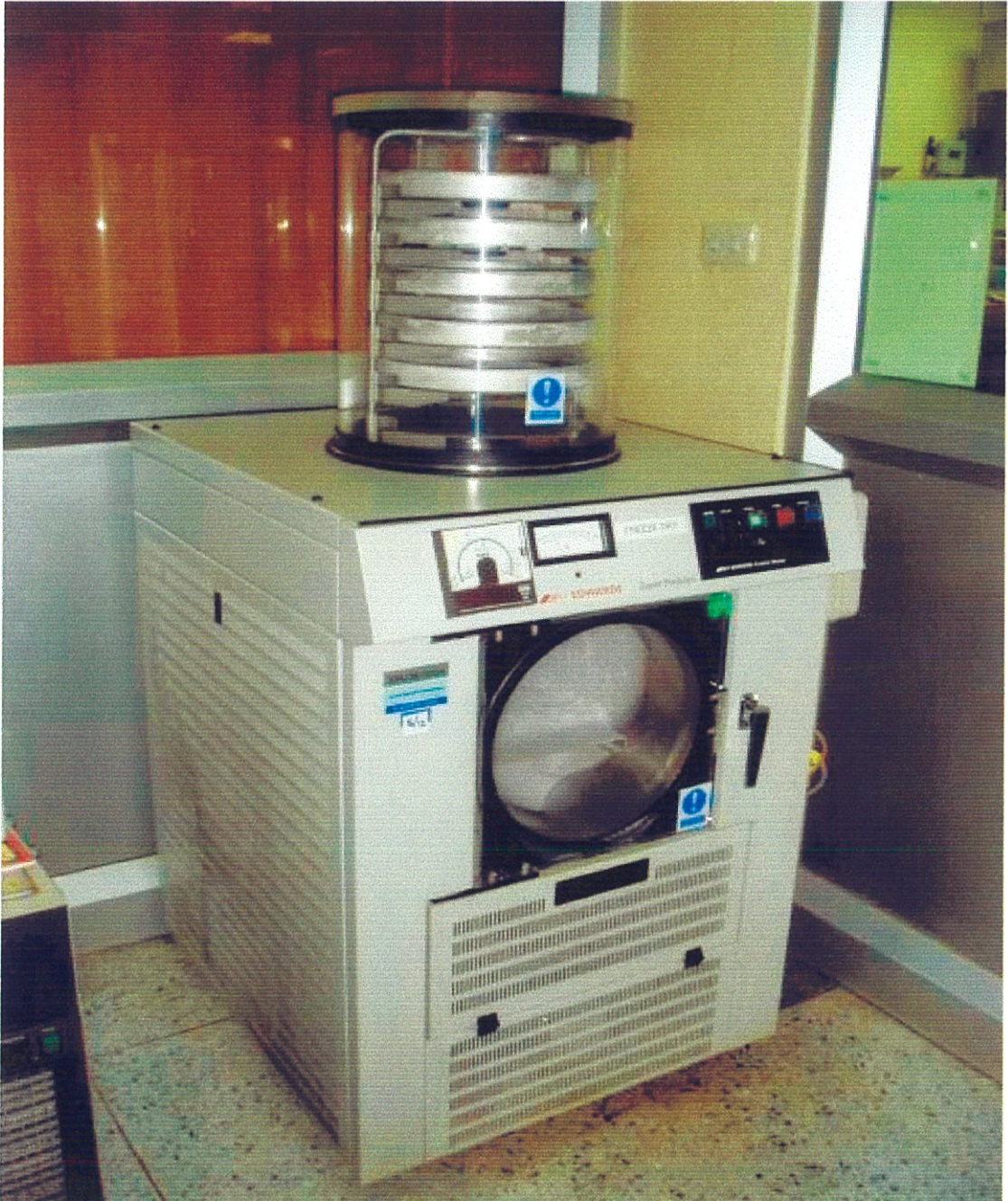
รูปที่ ง.1 ลักษณะและส่วนประกอบของเครื่อง Freeze - dryer ที่ใช้ในการทดลอง
